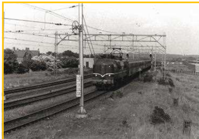
Foto 1 - Een E-loc (elektrische locomotief) van de 1200 serie met Plan E rijtuigen rijdt Zandvoort binnen (Foto Harry Opheikens 1973). Deze loc wordt straks losgekoppeld.
